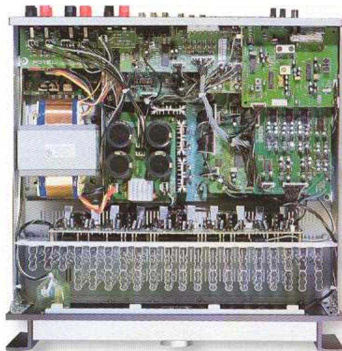
Intérieur : La nouvelle série 10 a fait l'objet d'un soin particulier sur l'alimentation dénommée El Core qui dispose de grosses capacités à faible résistance interne.
